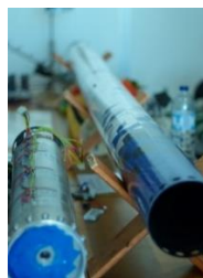
Rys. 1. Wybór połączeń przewodowych w całej rakiecie powoduje konieczność rozwiązania dodatkowych problemów prowadzenia okablowania
