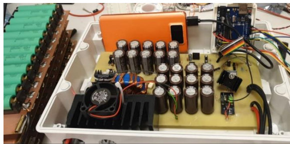
Rys. 1. Maximum power point tracker: a) schemat blokowy b) zdjęcie gotowego urządzenia
