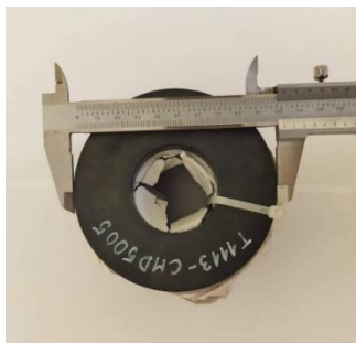
Rys. 1. Maszyna osiowo-promieniowa z magnesami trwałymi: a) wygląd i rozmiar rdzenia prototypu b) model maszyny
