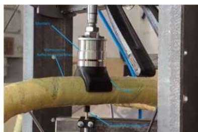
Rys. 2. Schemat przykładania siły i badania ugięcia w skonstruowanym stanowisku badawczym
