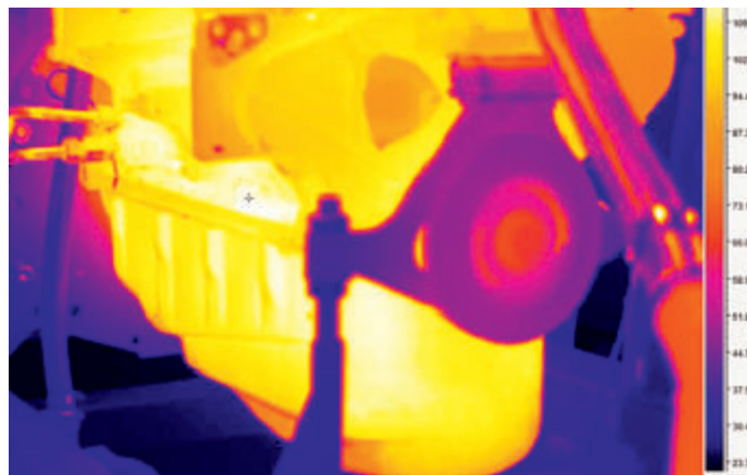
Obraz termowizyjny silnika spalinowego podczas pracy
