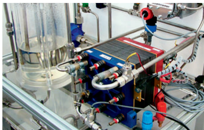
Ogniwo paliwowe, na którym ćwiczą studenci w laboratorium FHS
