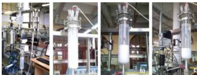
Ryc. 2. (a) Instalacja półprzemysłowa do otrzymywania modyfikowanych fotokatalizatorów; (b) zawiesina w trakcie obróbki; (c) zawiesina w trakcie sedymentacji; (d) zawiesina po zakończeniu sedymentacji Źródło: Archiwum prywatne.
