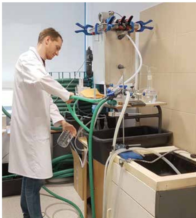
Dr inż. Bartosz Bogusławski pobiera próbki do analizy przemian ścieków prowadzących do powstania siarkowodoru w systemie kanalizacji sanitarnej
